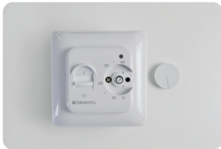
Termoregulators ar demontētu regulatoru
